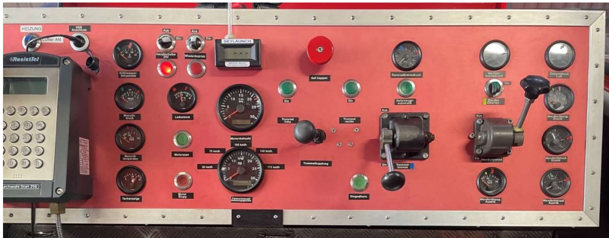
Bild 5: Praxisbeispiel einer möglichen Anordnung und Gestaltung von Windenbedienelementen
