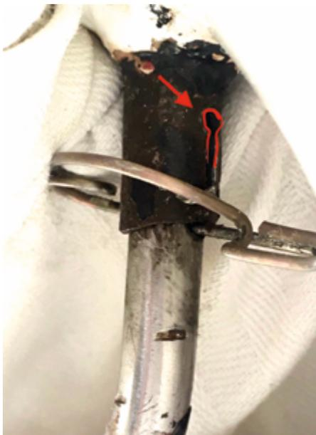
Die Sicherungsfunktion ist bei diesem Verschleiß nicht mehr gegeben, weil der Bolzen nicht mehr gehalten wird und nach unten rutschen kann. In einem aktuellen Fall hat dies zu einem Abfallen des Höhenleitwerks beim Rollen geführt. Verletzt wurde dabei glücklicherweise niemand.
